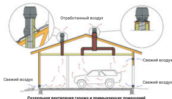
Раздельная вентиляция гаража и примыкающих помещений
